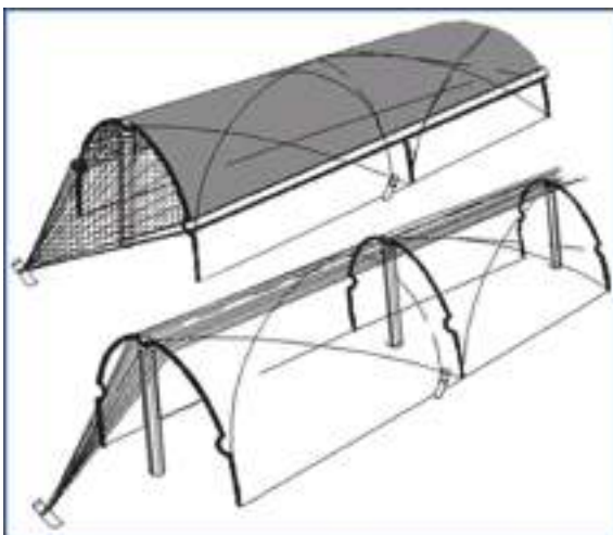
Figura 69 – Abertura na sobreposição dos filmes
