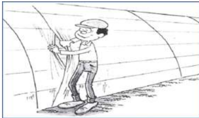
Figura 69 – Abertura na sobreposição dos filmes
